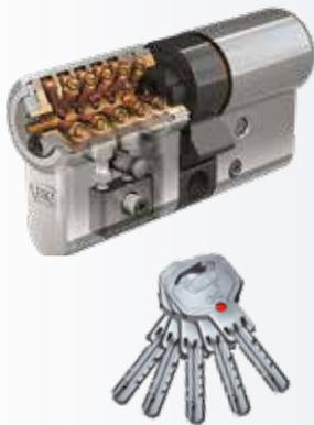
Anders als bei klassischen Schließsystemen werden die Sperrelemente im 3 Kurvensystem plus-Zylinder federfrei bewegt und nicht gegen eine Federkraft gedrückt.
